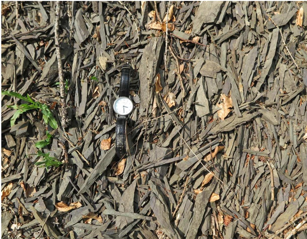
**Abb. 12:** Durch Verwitterung in Schiefergriffel zerfallener Griffelschiefer an einer Forstwegböschung im Harz bei Lautenthal.
